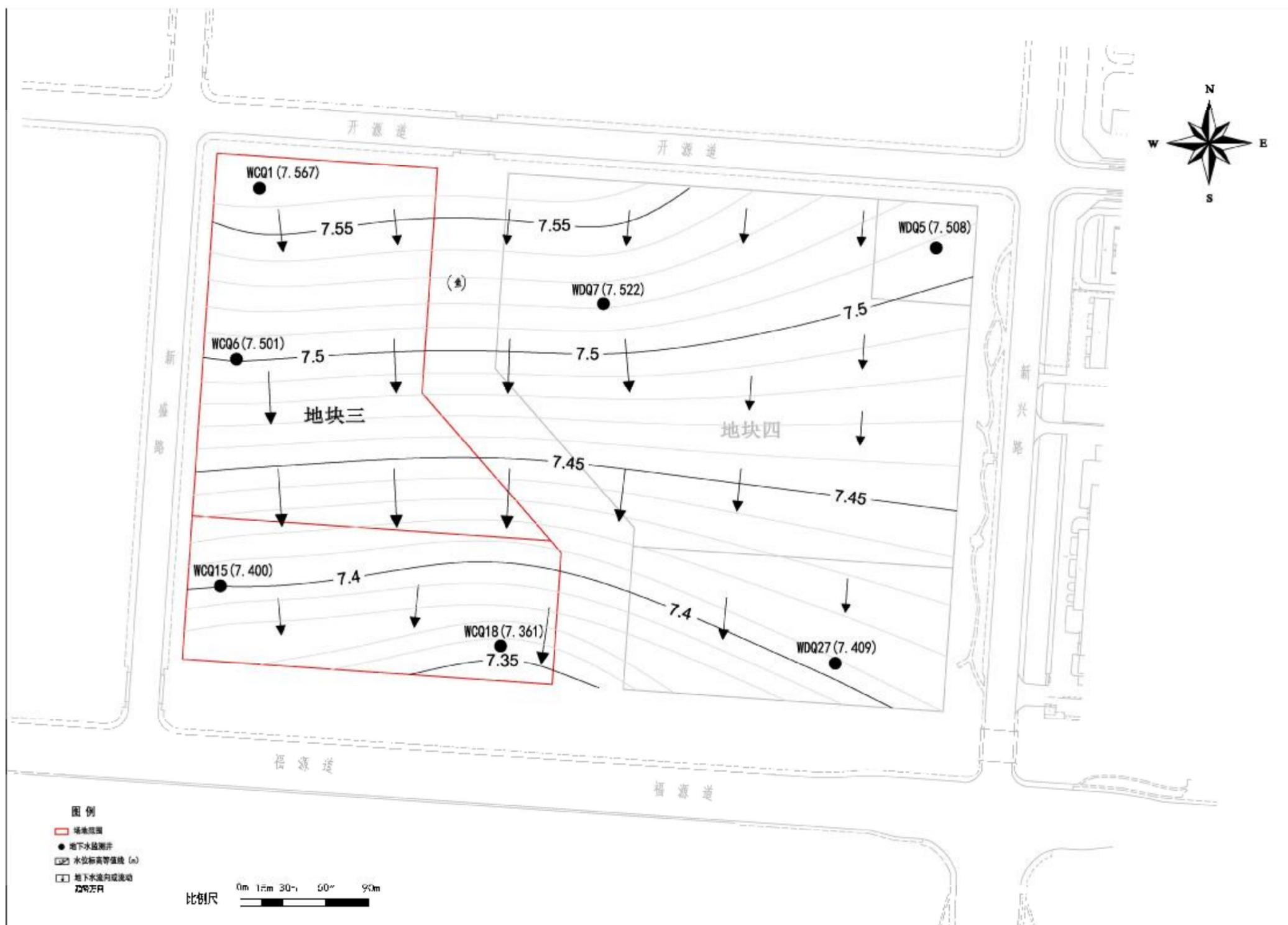
图 3.1-2 场地潜水水位高程等值线图 (2018 年 2 月)
